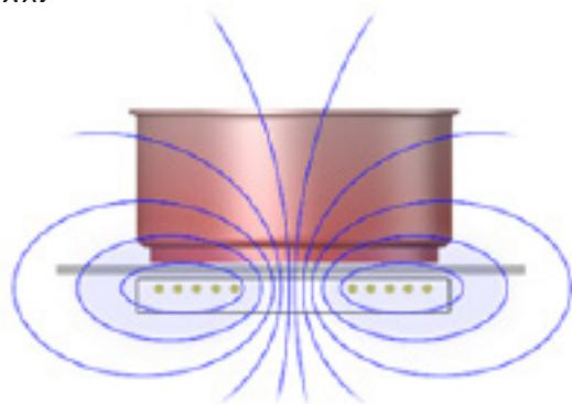
Das Grundprinzip des Induktionskochens ist sehr einfach. Wenn der Topf auf die Keramikoberfläche des Kochfeldes gestellt wird, gerät er in das vom Induktionssystem erzeugte Magnetfeld.
