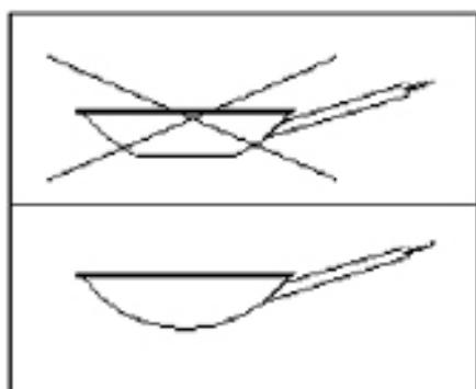
Der Generator akzeptiert keine ungeeigneten Töpfe. Jedes andere Produkt, das in diesem Abschnitt nicht aufgeführt ist, wird automatisch als ausgeschlossen und ungeeignet für den ordnungsgemäßen Betrieb von Induktionsgeneratoren betrachtet.
